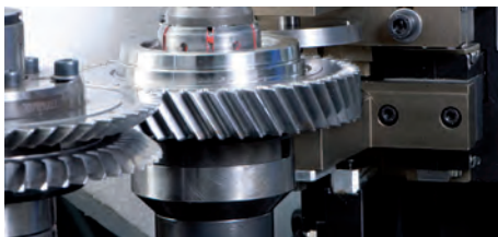
Unità integrata di sbavatura smussatura su RASO 250 TP.
